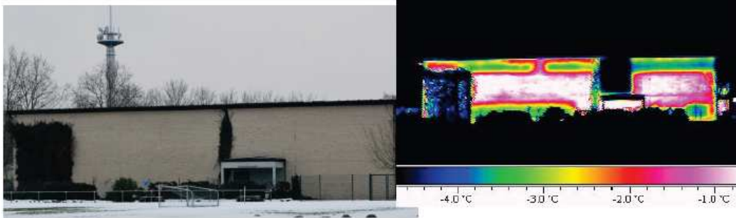
Thermogramm einer Sporthalle
